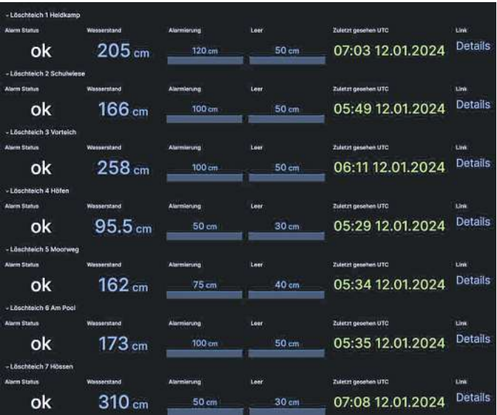
Das „Dashboard“ auf dem Monitor bei der Feuerwehr Kalübbe zeigt die Pegelstände der Löschteiche an. FOTO: ADDIX/BOJE SJUT
